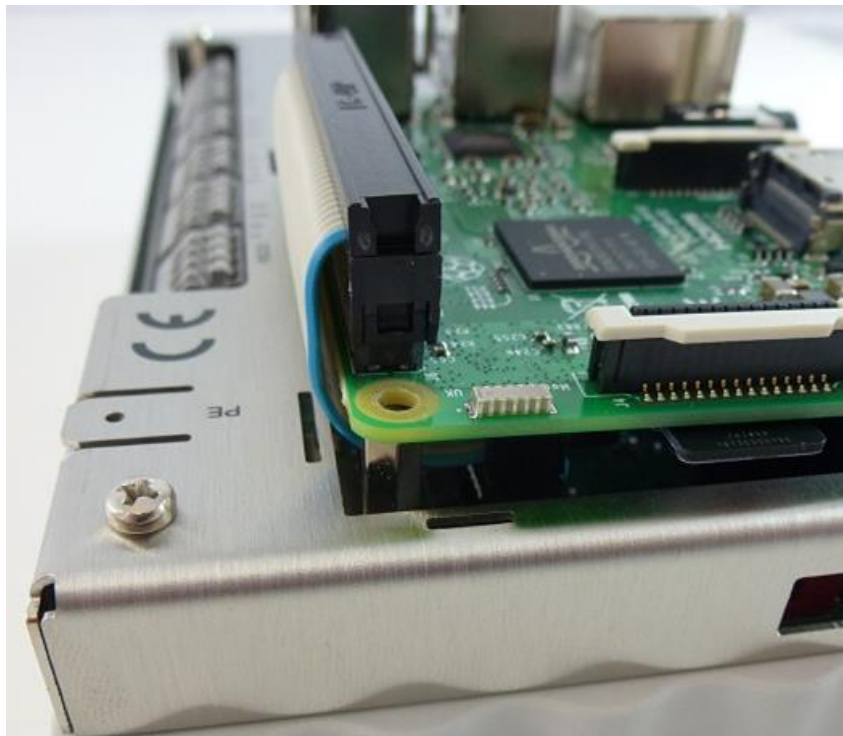
Abbildung 23: Optimaler Verlauf des Flachbandkabels
