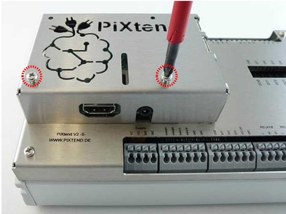
Abbildung 25: Obere Haube montieren - erster Schritt
