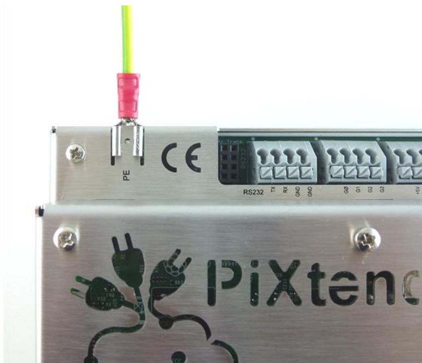
Abbildung 27: Schutzleiteranschluss (PE) an der PiXtend V2 -S- Haube
