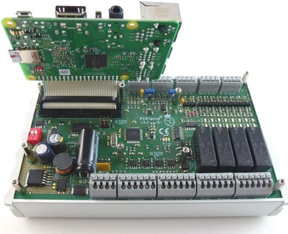
Abbildung 19: Raspberry Pi von PiXtend gelöst (Flachbandkabel bleibt verbunden)
