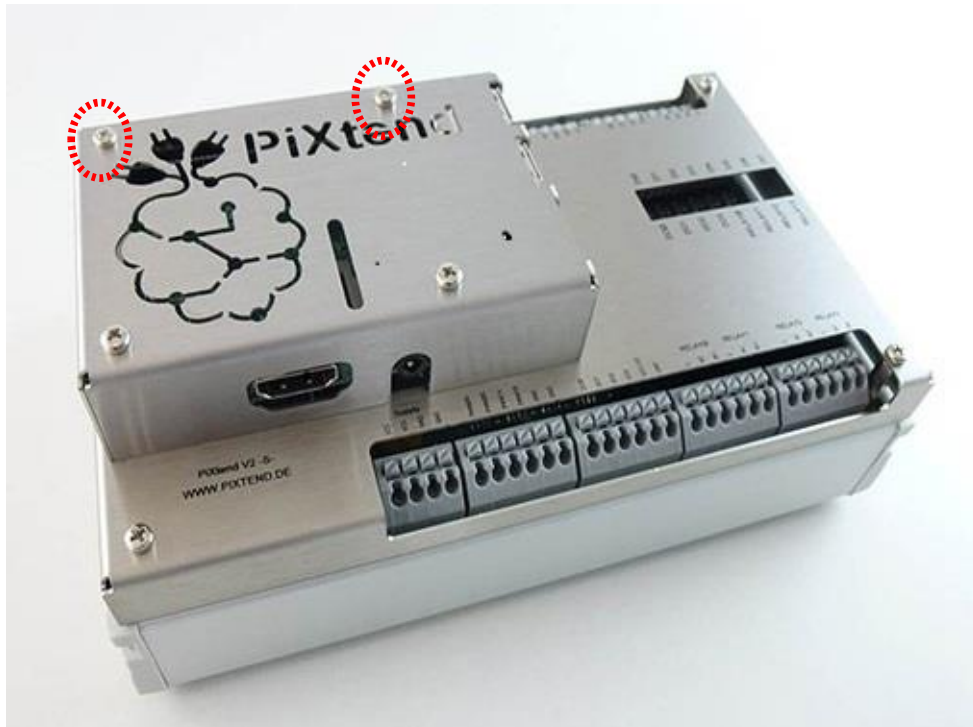
Abbildung 26: Edelstahlhaube fertig montiert
