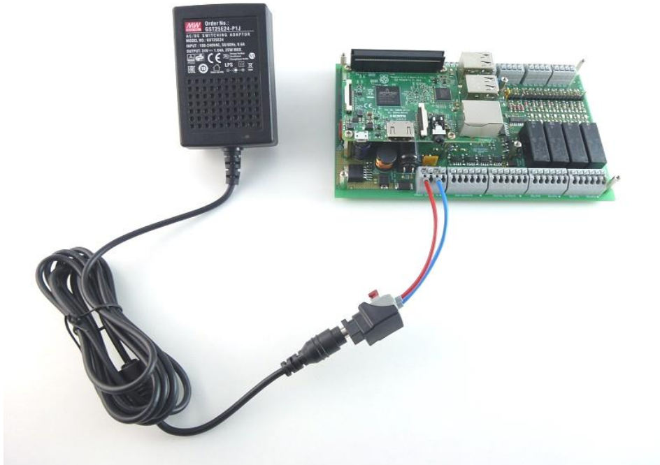
Abbildung 36: Anschluss des Netzteils an PiXtend V2 -S-
