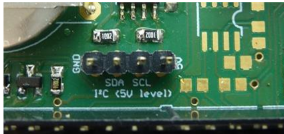
Abbildung 43: Stiftleiste - I 2 C auf 5 V-Pegel
