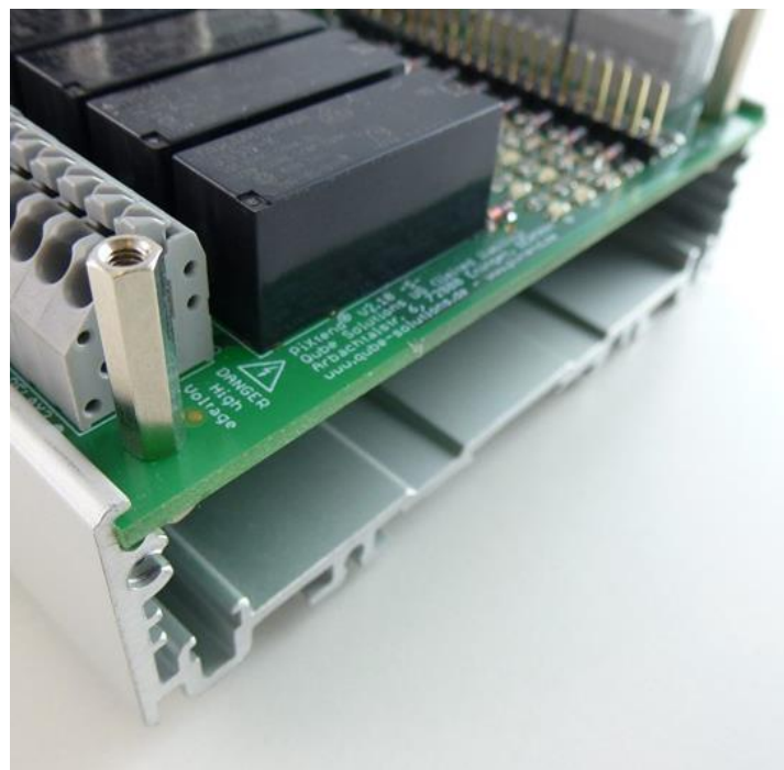
Abbildung 13: PiXtend und Gehäuseprofil zusammenfügen
