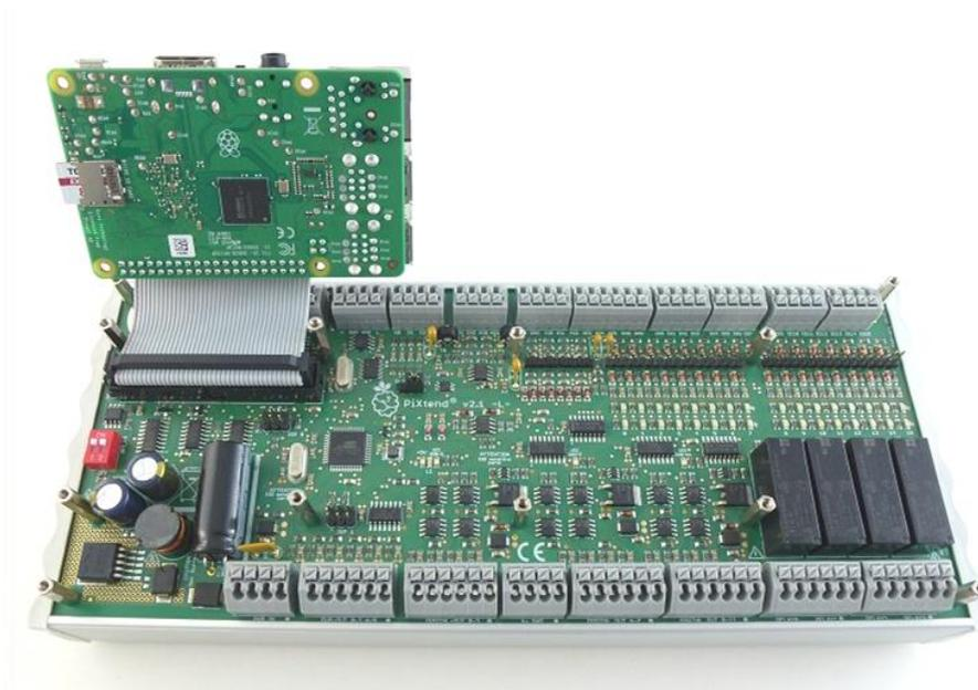
Abbildung 19: Raspberry Pi von PiXtend gelöst
