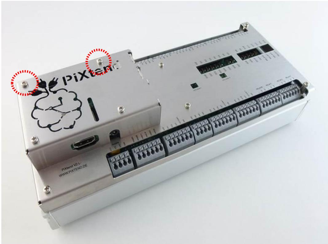
Abbildung 26: Edelstahlhaube fertig montiert
