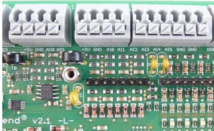
Abbildung 69: Anschlussleisten - analoge Ein- und Ausgänge
