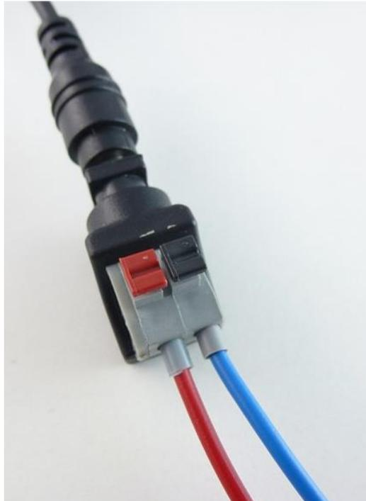
Abbildung 38: Anschluss der Leitungen an den Adapter
