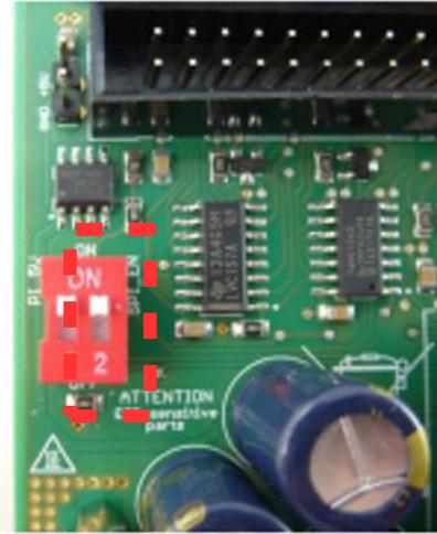
Abbildung 51: DIP-Schalter: SPI\_EN
