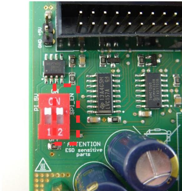
Abbildung 28: Schalter – „SPI\_EN“
