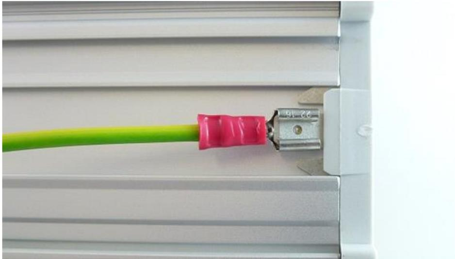
Abbildung 16: Hutschiengehäuse - Schutzleiter (PE) angeschlossen
