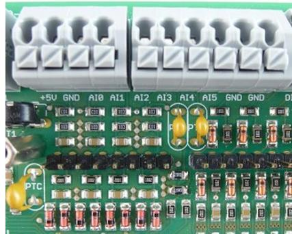
Abbildung 70: Anschlussleisten - analoge Eingänge
