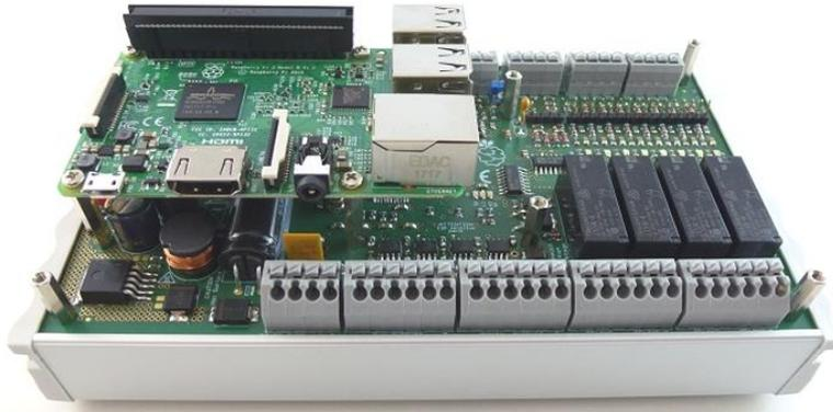
Abbildung 14: Hutschienegehäuse montiert
