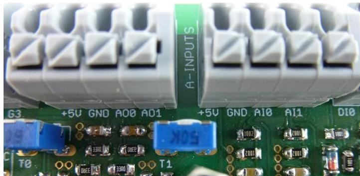
Abbildung 63: Anschlussleisten - analoge Ein- und Ausgänge
