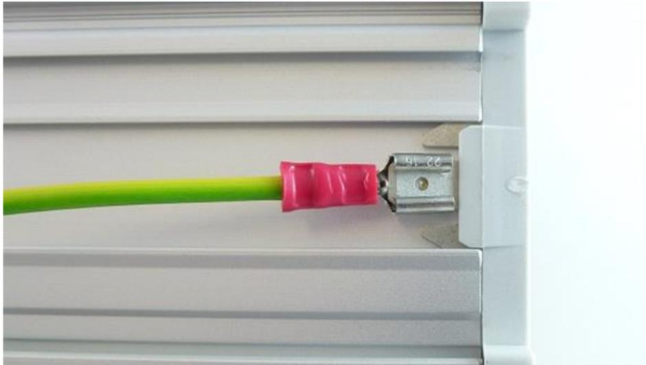
Abbildung 16: Hutschienegehäuse - Schutzleiter (PE) angeschlossen
