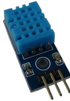
Abbildung 72: Temperatur- und Luftfeuchtesensor DHT11
