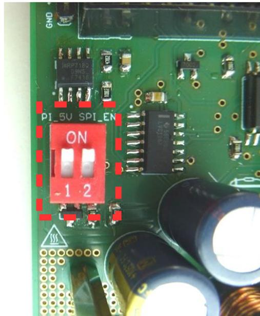
Abbildung 28: Schalter – „SPI\_EN“
