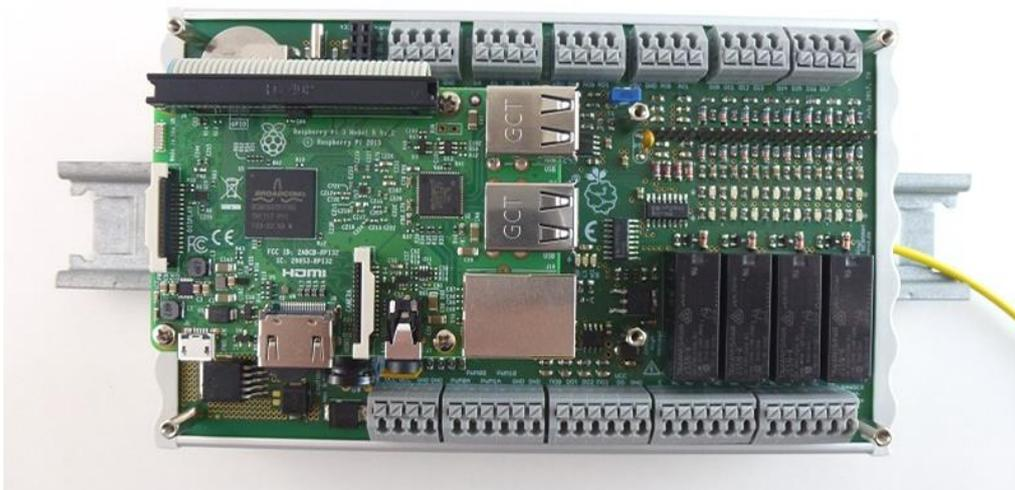
Abbildung 18: Hutschiennenmontage abgeschlossen
