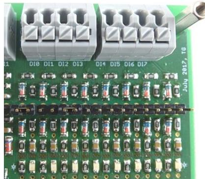
Abbildung 52: Anschlussleiste - digitale Eingänge
