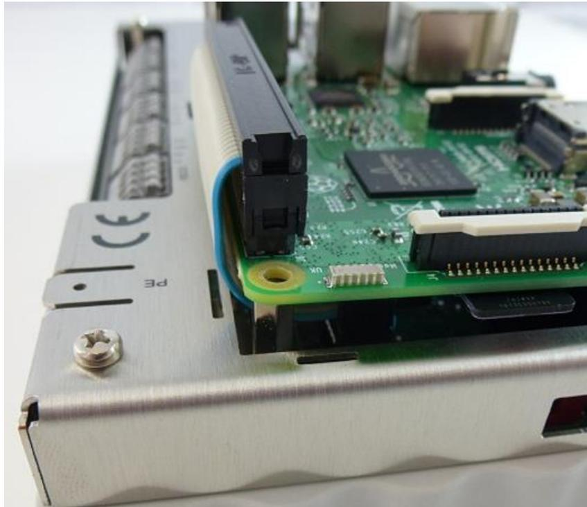
Abbildung 23: Optimaler Verlauf des Flachbandkabels
