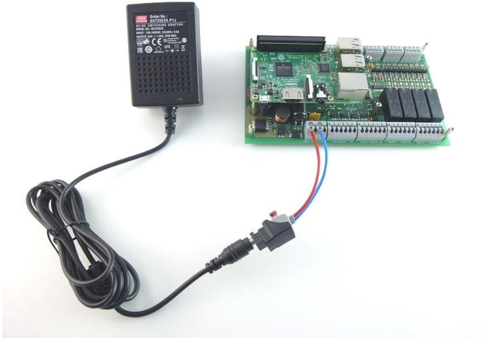
Abbildung 36: Anschluss des Netzteils an PiXtend V2 -S-
