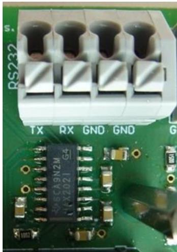
Abbildung 76: Anschlussleisten - serielle Schnittstellen
