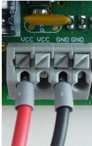
Abbildung 39: Anschlussleiste - Spannungsversorgung
