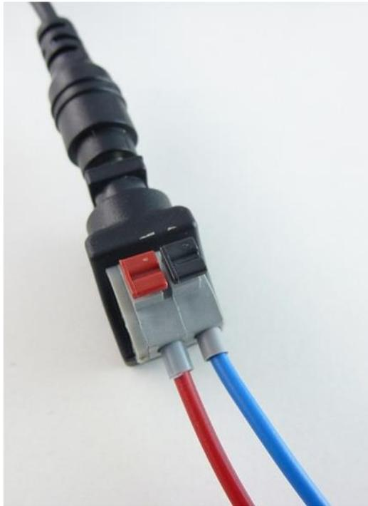
Abbildung 34: Anschluss der Leitungen an den Adapter
