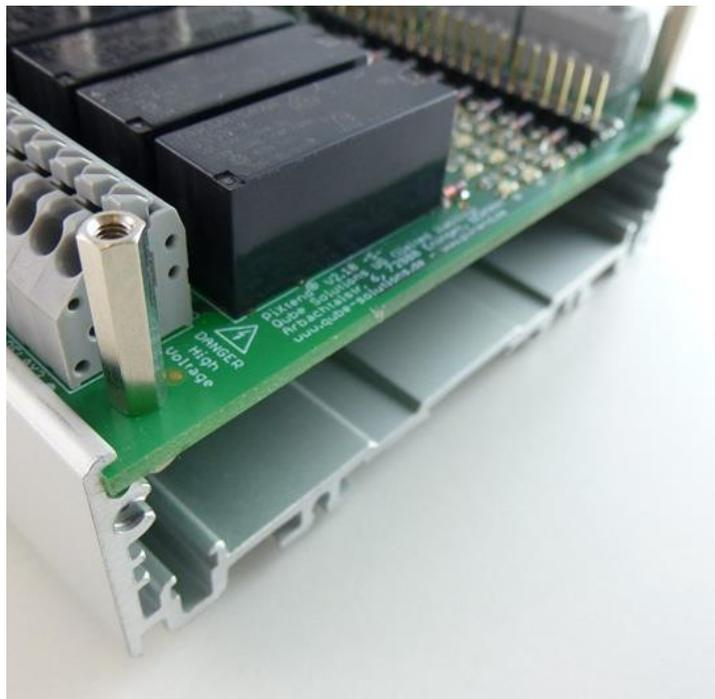
Abbildung 13: PiXtend und Gehäuseprofil zusammenfügen
